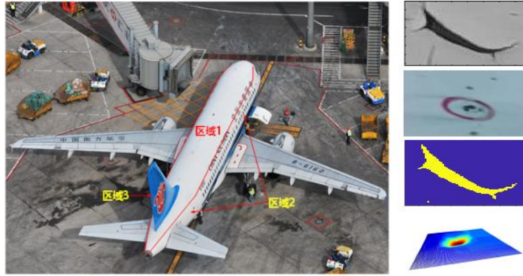
图 21 东方航空飞机表面缺陷检测示意图
